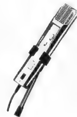
DX 11 1984 Richtmikrofon mit elektronischer Nachhalleinrichtung
