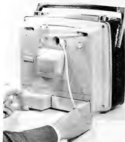
Bild 14. Rückansicht des Astronaut 1819: Die beiden Dryfit-Batterien und das Ladegerät werden in eine eigene Tasche eingeschoben
