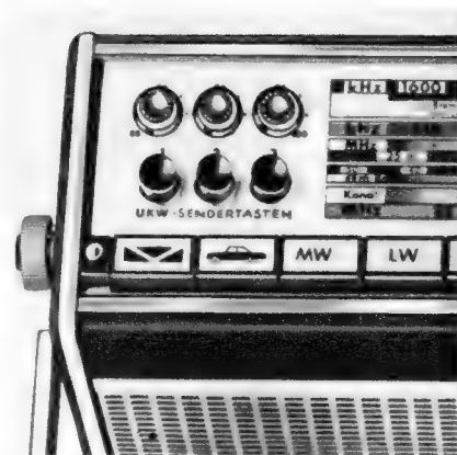
Bild 1. Die drei Stationstasten des Reiseempfängers Bajazzo de Luxe mit den darüberliegenden Abstimmknöpfen
